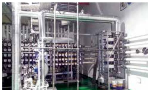
Установка блендинга с блендером с одновременным дозированием (SMB) и манифольдом для автоматического производства смазочных материалов (до 40 партий/сутки), GS Caltex Corporation, г. Сеул / Южная Корея, 2015г.
