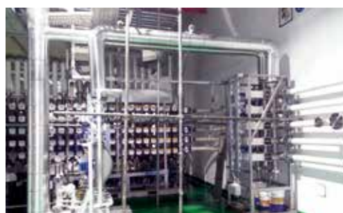
Schmierstoffmischanlage mit Simultaneous Metering Blender (SMB) und Dosiermanifold zur automatisierten Herstellung von bis zu 40 Batchmischungen pro Tag, GS Caltex Corporation, Seoul / Südkorea, 2015.
