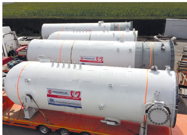
OA0 Naftan, Nowopolozk, Belarus: Engineering und Lieferung von zwei Extraktionskolonnen für Umbau PDA-Anlage
